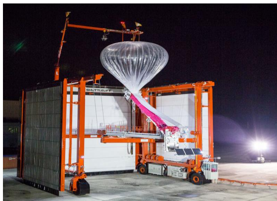
Gambar 4. Autolauncher Proyek Loon Sumber: Google di dalam (Dent, 2017)
